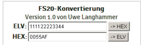
Bild 9: FS20-Konvertierung, hier das Beispiel für den Hauscode 1111 2222 und Adresscode 33 44
