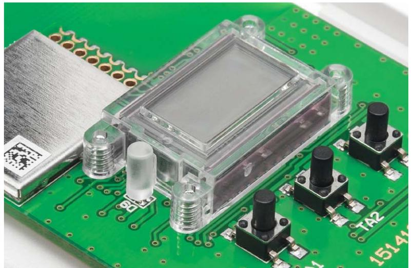
Bild 9: Der Displayhalter wird von der Platinenrückseite her vorsichtig verschraubt. Links ist der Lichtleiter für die Geräte-LED zu sehen.
