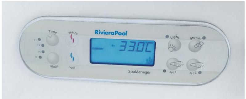
Bild 1: Das Bedienteil der Whirlpool-Steuerung
