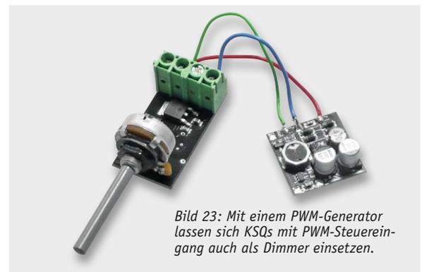
Bild 23: Mit einem PWM-Generator lassen sich KSQs mit PWM-Steuereingang auch als Dimmer einsetzen.
