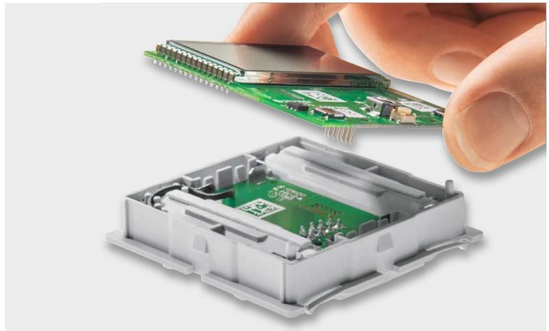
Bild 8: So wird die Basisplatte auf die Spannungsversorgungsplatte aufgesetzt.
