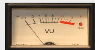
Ein analoges VU-Meter, hier bereits mit einem separaten LED-Indikator (Quelle: Wikipedia [1])
