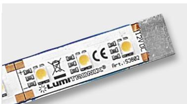
Bild 19: Bei LED-Streifen werden zur besseren Lastverteilung mehrere Widerstände je LED eingesetzt.
