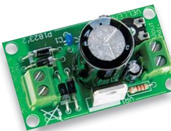
Hier brauchen Sie nur noch einen Netztransformator, und Sie haben bereits ein in weiten Grenzen einstellbares Gleichspannungsnetzteil.
