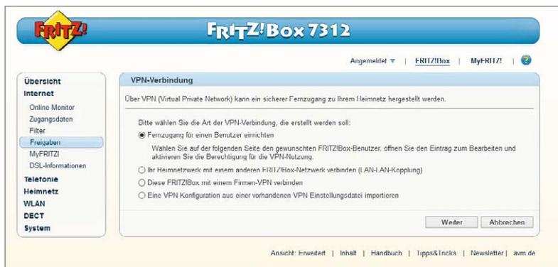
Bild 4: Anlegen einer VPN-Verbindung am Beispiel einer AVM FRITZ!Box
