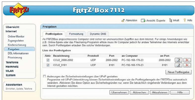
Bild 3: So erfolgt die Portweiterleitung bei einer AVM FRITZ!Box
