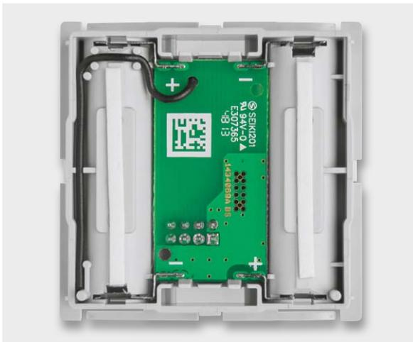
Bild 7: Die Unterschale mit eingelegter Spannungsversorgungsplatte. Hier ist die Lage der Transceiver-Antenne gut zu sehen.
