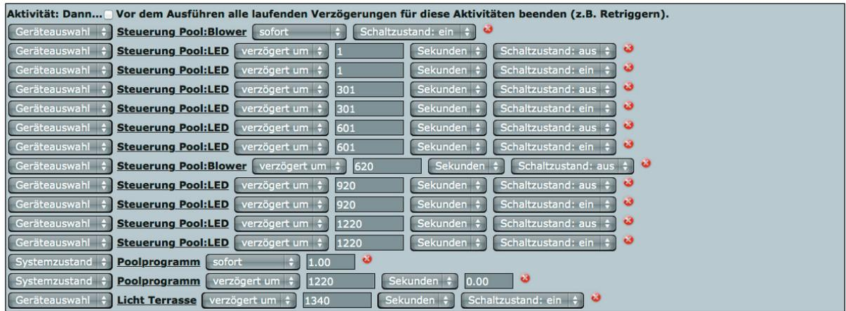
Bild 14: Das Programm zur Automatisierung bei der Pool-Benutzung
